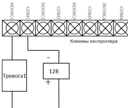
Рисунок 4-7 Подключение внешнего тревожного устройства
